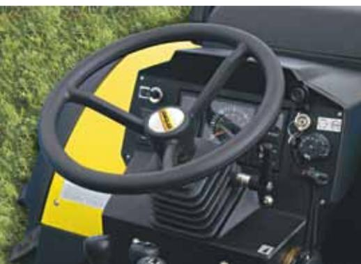
Inoltre, nella versione reversibile dei **Mars EP**, il modulo di guida (sedile-volante-cruscotto) ruota in soli 5 secondi in modo pratico e sicuro senza staccare alcuna connessione.
