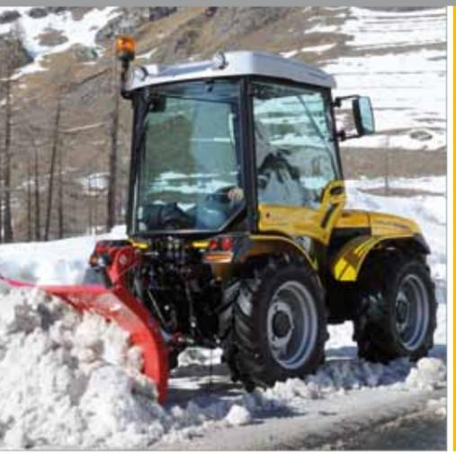
Sono disponibili in versione **Lusso e Comfort**, quest'ultima dotata di climatizzatore posto all'interno del telaio del tetto, così da non aumentare l'altezza del mezzo.
