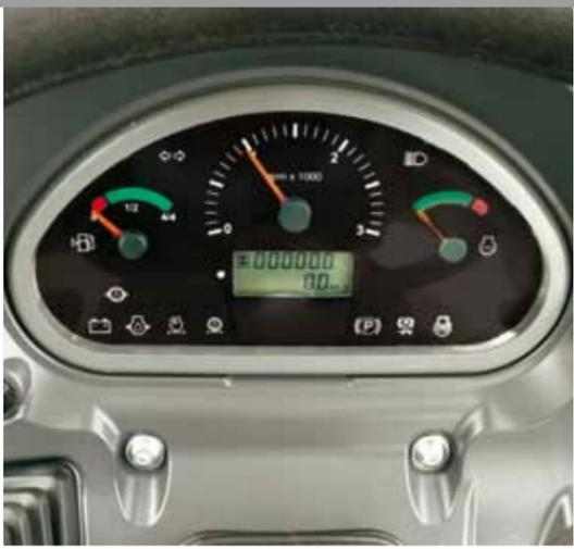
La **strumentazione** digitale è inserita in modo elegante in una console con schermo antiriflesso e prevede la lettura dei giri motore, velocità di avanzamento e velocità di rotazione della presa di forza.
